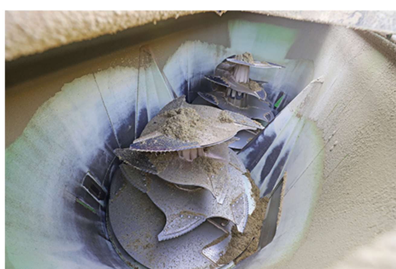
L'interno della vasca di miscelazione con le due coclee
