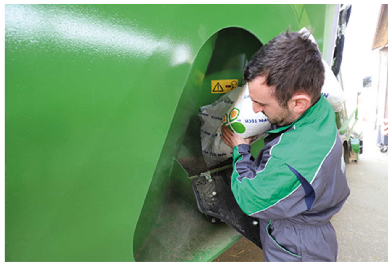
Il comodo vano di accesso alla vasca di miscelazione per inserire prodotti speciali
