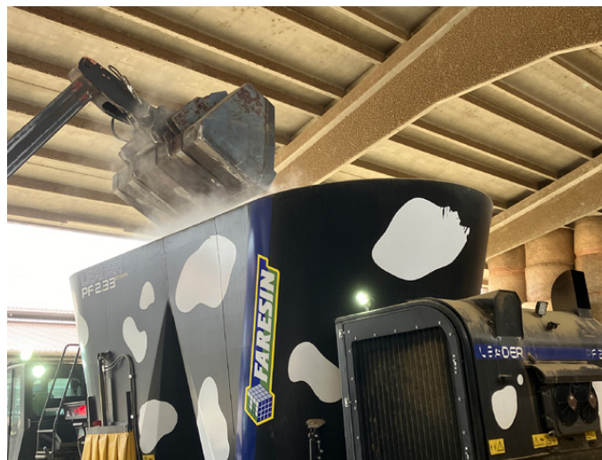
Il carro 2.33 è la versione più grande del semovente a doppia coclea
