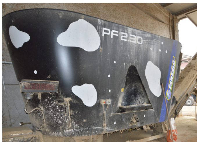
La base per le diverse ricette è preparata in un carro Faresin stazionario, sfruttando così l'energia elettrica prodotta dai pannelli fotovoltaici
