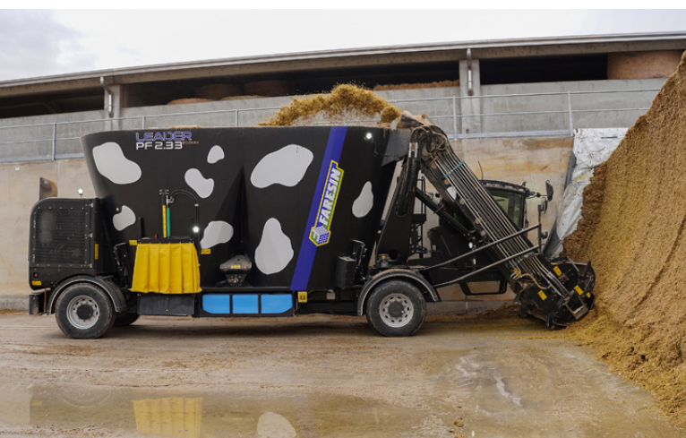
La componente principale della razione è, ovviamente, l'insilato di mais, raccolto grazie alla fresa con mulino del Leader PF 2
