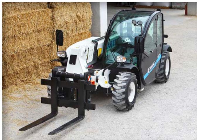
Il 6.26 Full Electric ha **dimensioni compatte**, con un passo di 2.525 mm, altezza di 1.935 mm e carreggiata di 1.550 mm, per una **massa complessiva, senza attrezzi, di 4.800 kg**. Il telescopico si caratterizza da un'**ottima abitabilità e visibilità della cabina**
