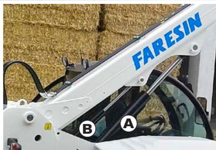
Il braccio, a uno sfilo, raggiunge un'altezza massima di 5,8 m. Nel dettaglio i due pistoni idraulici: il più esterno (A) di dimensioni maggiori serve al sollevamento del braccio (capacità di carico max 2.600 kg); il più interno (B) interviene per mantenere il parallelismo della piastra portattrezzi
