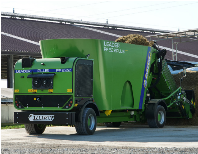
Il carro miscelatore in azione: la fase di prelievo dell'insilato dalla trincea. La macchina è un Leader PF 2.22 Plus Ecomix, della Faresin
