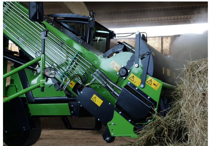
Il mulino, uno dei punti di forza di questo carro Faresin. Dicono i Perletti: è in grado di tagliare 5 quintali di fieno in soli 5 minuti.
