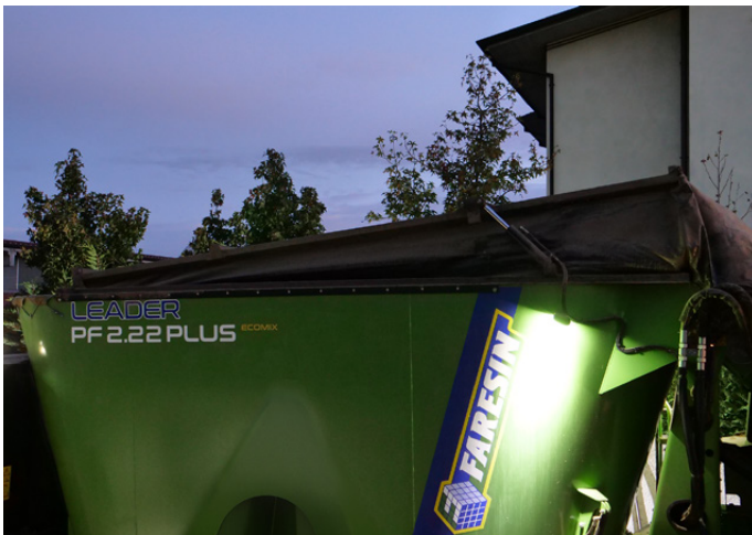
La copertura della vasca di questo carro miscelatore della Faresin è realizzata in acciaio resistente. Evita la dispersione delle polveri.
