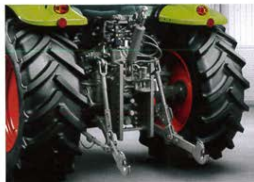
L'Atos dispone di una capacità di sollevamento posteriore massima fino a 4,8 t per Atos 300 e fino a 3,6 t per Atos 200.
