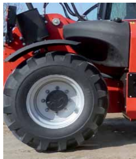
Il serbatoio del gasolio è conformato in modo da completare utilmente la copertura della ruota destra.
