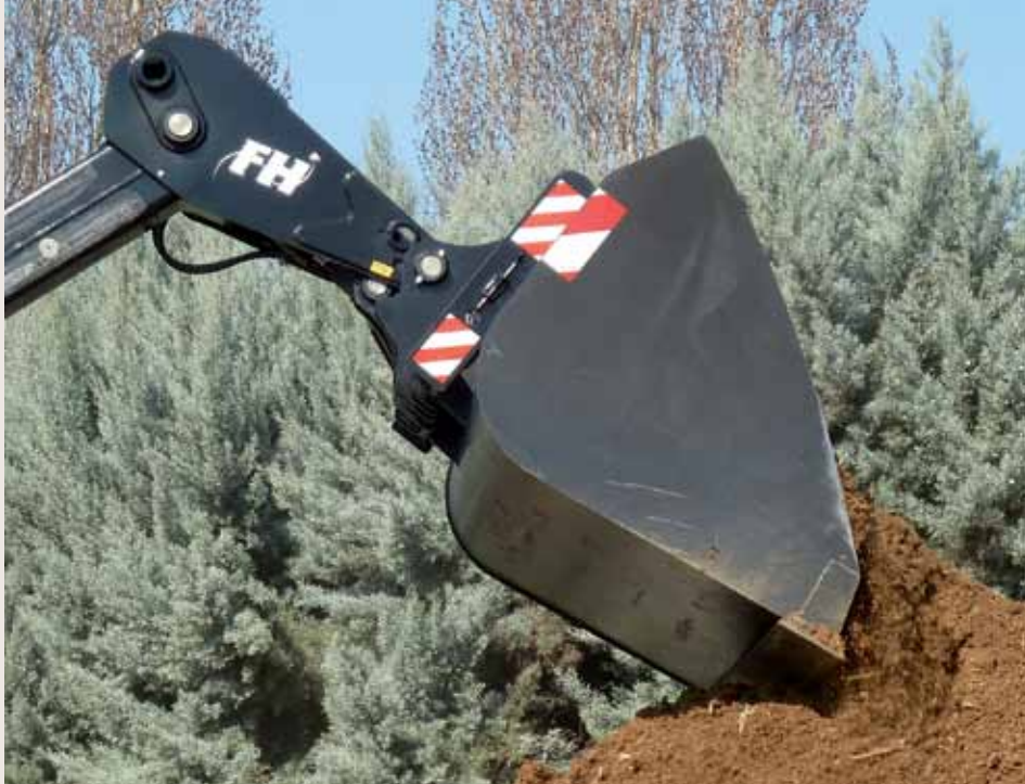
Nella routine di lavoro delle prove, il Faresin FH 7.30 Compact era abbinato ad una benna per materiali leggeri con volume utile di carico di 1,8 m 3 .
