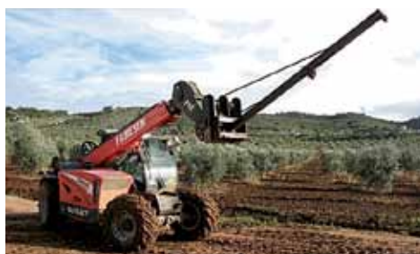
L'FH 7.30 Compact è proposto da Faresin anche in versione "Olitract", equipaggiata con motori più performanti e accessori specificamente studiati per l'olivicultura, tra cui una testata per lo scuotimento degli alberi e la raccolta del prodotto mediante captatore ad ombrello rovesciato.
