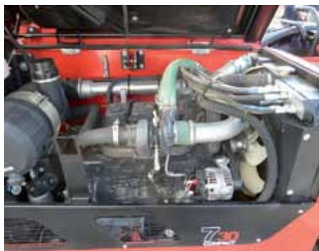
Il motore montato sull'FH 7.30 Compact in prova era un Deutz a 4 cilindri turbocompresso tarato (in modo davvero conservativo) a 102 CV a 2300 giri/min e 430 Nm a 1350 giri/min.
