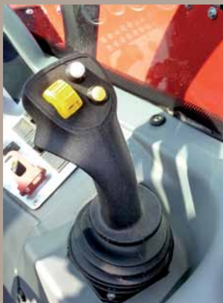
La gestione del braccio telescopico e della relativa base di fissaggio dell'attrezzo terminale si esegue tramite un joystick con impugnatura ergonomica posto sulla destra del posto di guida. Nel riquadro la legenda dei comandi che sovrintendono ai vari movimenti.
