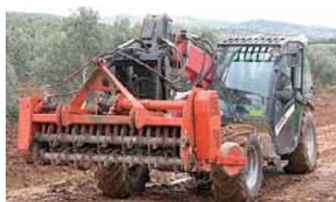
L'FH 7.30 Compact è proposto da Faresin anche in versione "Olitract", equipaggiata con motori più performanti e accessori specificamente studiati per l'olivicultura, tra cui una testata per lo scuotimento degli alberi e la raccolta del prodotto mediante captatore ad ombrello rovesciato.
