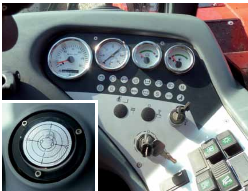
Il cruscotto è di tipo tradizionale, ma gli strumenti sono ben visibili e di immediata leggibilità. Nel riquadro: l'inclinometro a bolla, molto utile per mantenere la miglior orizzontalità in una macchina che movimentata carichi gravosi.
