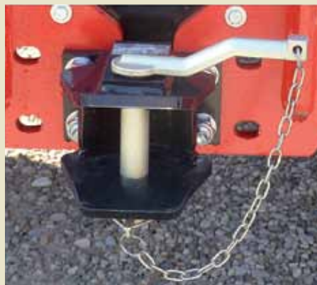
La versione agricola dell'FH 7.30 Compact prevede un sollevatore con attacco a 3 punti di categoria 2, una pdp integralmente meccanica (in basso a sinistra, a 540 o a 1000 giri/min) e un gancio di traino (in basso a destra, omologato CUNA, di categoria C).
