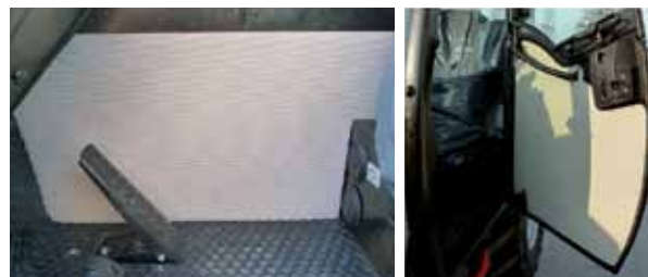
In alto: nonostante la presenza del FOPS, la visibilità dell'attrezzo terminale dal posto di guida verso l'alto è ottima. In basso: l'insonorizzazione consente un abbattimento della rumorosità di 4,5 dB(A).
